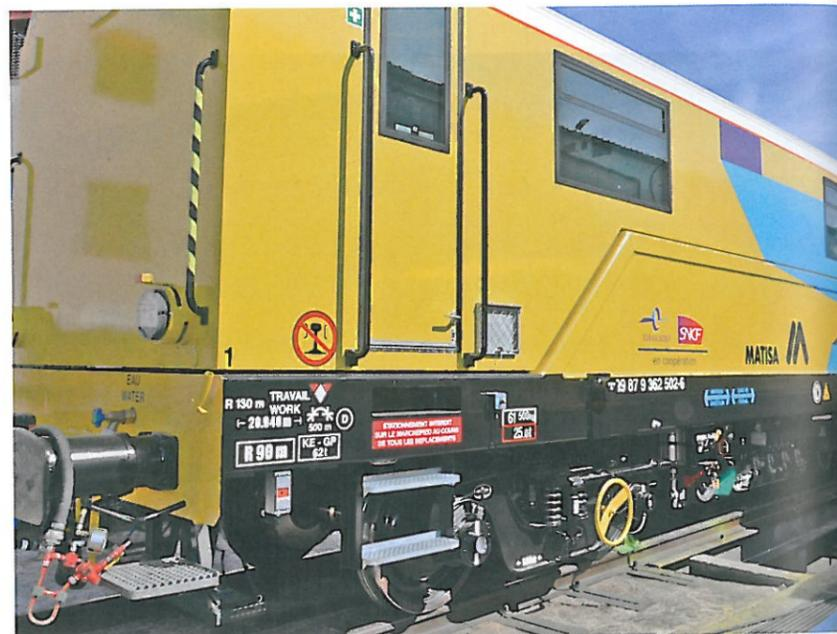
! Bild 6: MATISA-Gleismesswagen mit RC25NT-Drehgestellen
