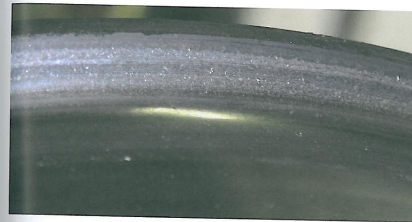
Bild 5: Fettauftrag am Spurkranz eines Brammenwagens
