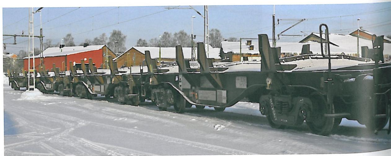
Bild 4: Brammenwagen mit RC25NT-Drehstellen
